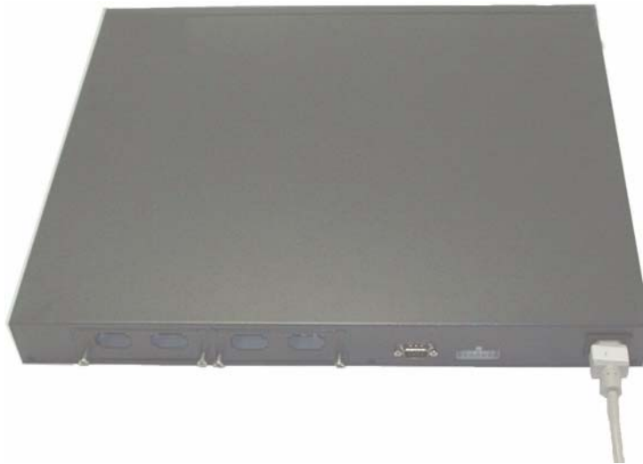
Figure 1-2. Branchement du câble d'alimentation
